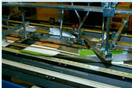
Doppel-Pop-up Verlauf erst über Taschenfalz, dann 3-facher Pflugfalz mit jeweiliger Verleimung + aufschneiden am Schneidetisch + Aufspendung (Einklebung) eines Zugmechanismus.
